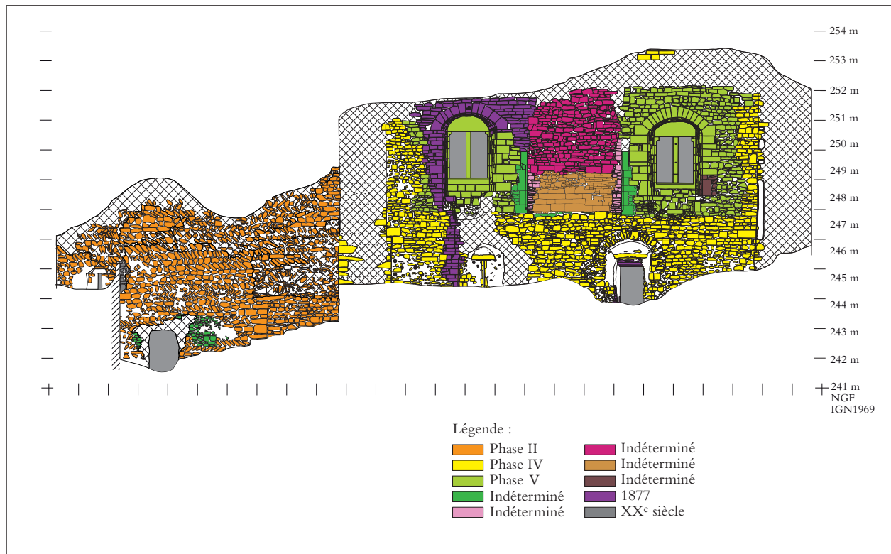
Fig. 11 : phasage des élévations des bâtiments 1 et 2, face nord (relevé et DAO : F.B.)
