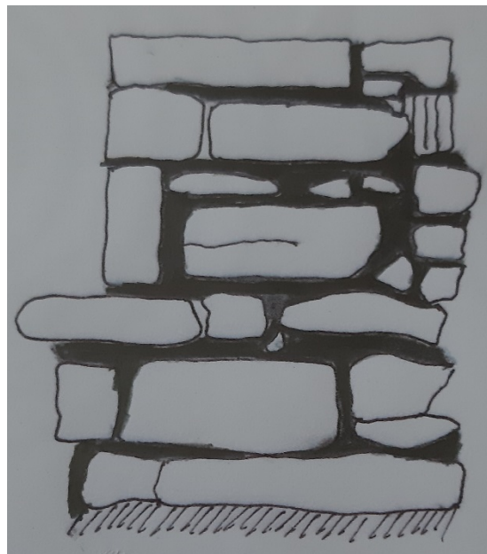
Fig. 21 - Relevé 5 = Fondations du mur de courtine contre la tour ronde d'artillerie
